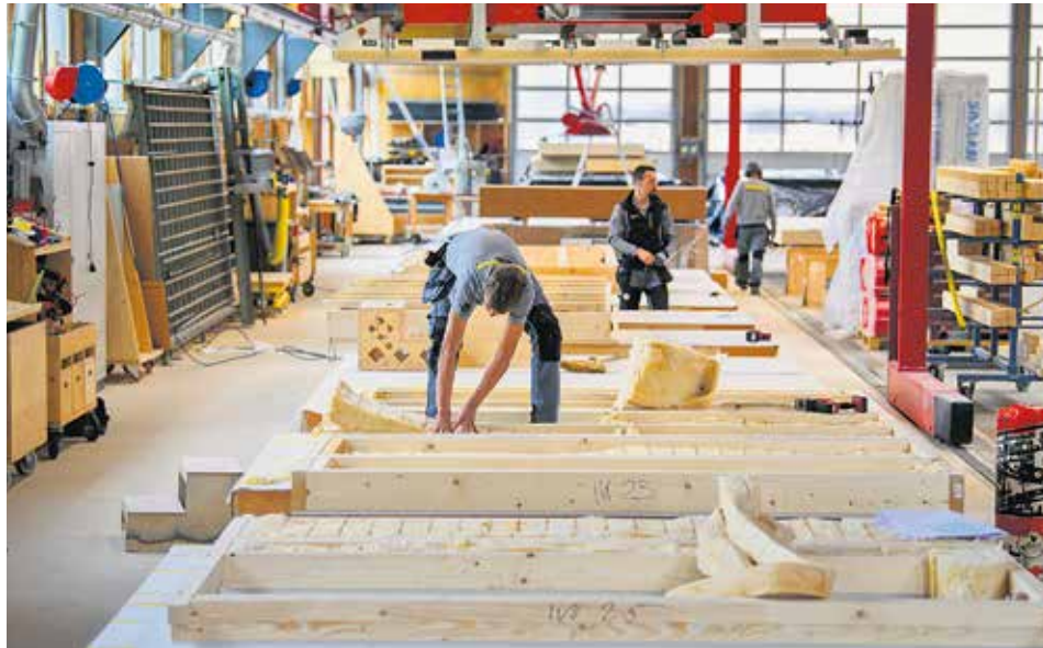
Nik Stuber (l.) und Markus Steiner führen die Stuberholz AG in die Zukunft. Ein wichtiges Element der Unternehmensstrategie ist der Elementbau im Werk. Im Vergleich zum Bauen vor Ort erhöht dies Qualität und Geschwindigkeit der Produktion. BILDER: RAPHAEL MOSER
